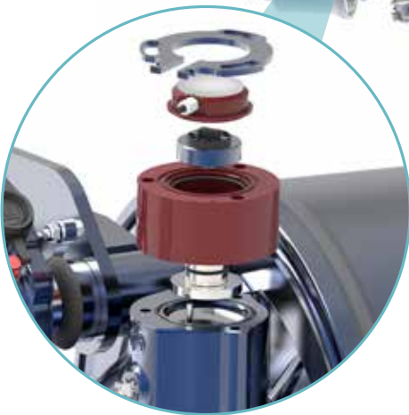
integrierter Sicherheitswinkelgeber in der AGRO Turn Lenkachse
